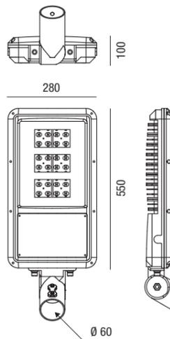
Il cavo in dotazione è del tipo H05RVV-F - 2x1mm<sup>2</sup>
